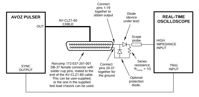
NOTE: BOTH DIODES ARE SHOWN ORIENTED FOR A POSITIVE OUTPUT. REVERSE BOTH DIODES FOR NEGATIVE OPERATION.
