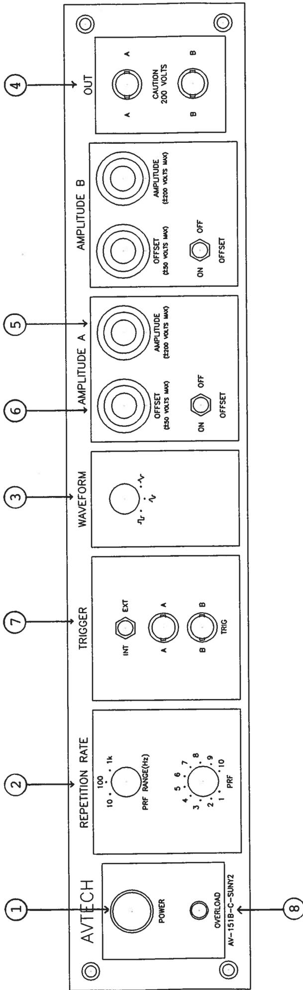
Fig. 2 FRONT PANEL CONTROLS
