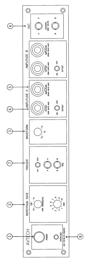
Fig. 2 FRONT PANEL CONTROLS
