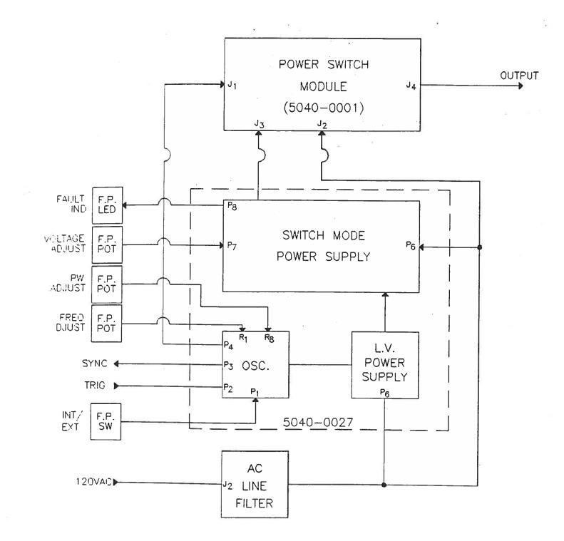
FIGURE 1. SVX PULSER BLOCK DIAGRAM
