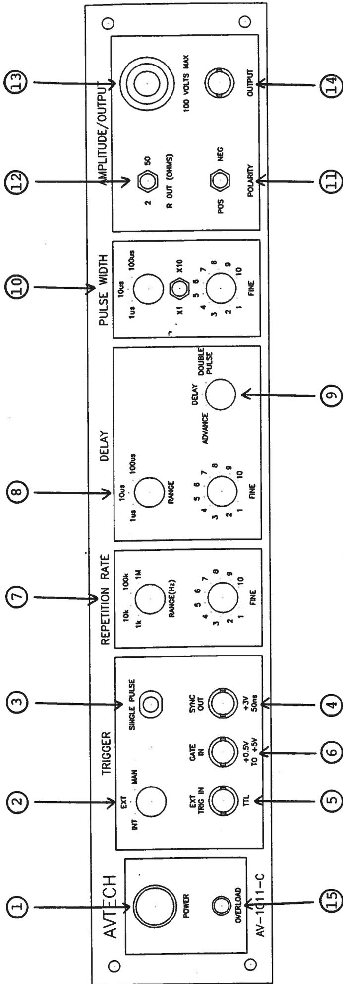
FIG. 1 FRONT PANEL CONTROLS
