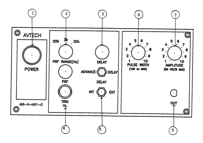
Fig. 2. FRONT PANEL CONTROLS
