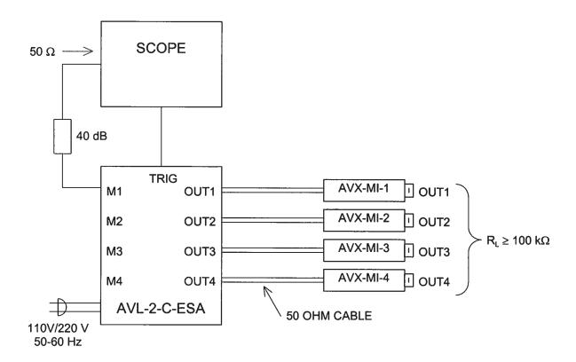
FIG 1 - BASIC SYSTEM CONFIGURATIONS
