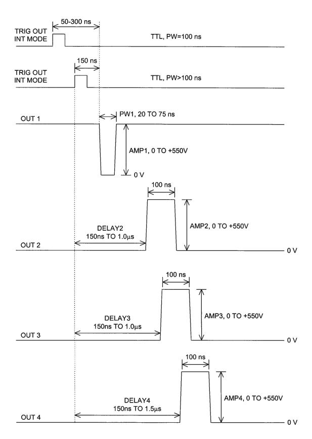
FIG 2 - TRIGGER WAVEFORMS AND AVX-M1 OUTPUT WAVEFORMS
