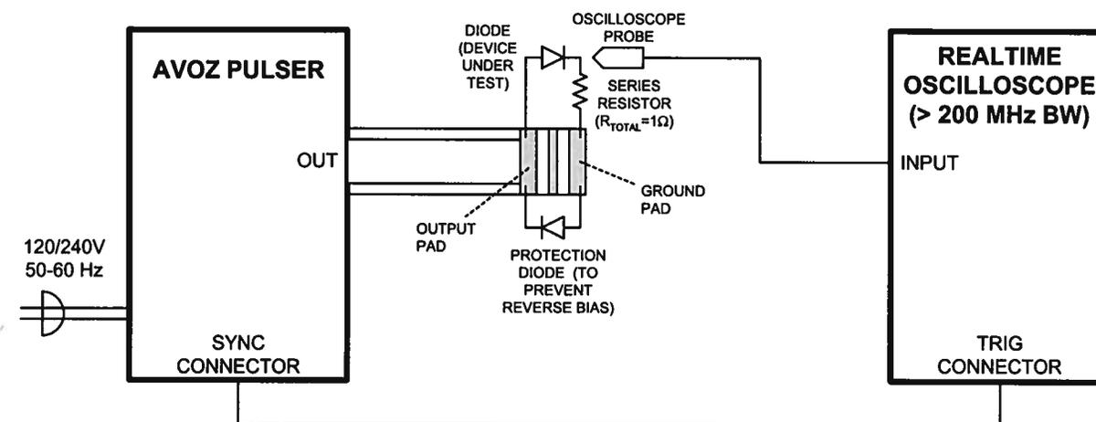
NOTE: BOTH DIODES ARE SHOWN ORIENTED FOR A POSITIVE OUTPUT. REVERSE BOTH DIODES FOR NEGATIVE OPERATION.
