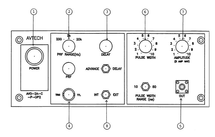
Fig. 2: FRONT PANEL CONTROLS
