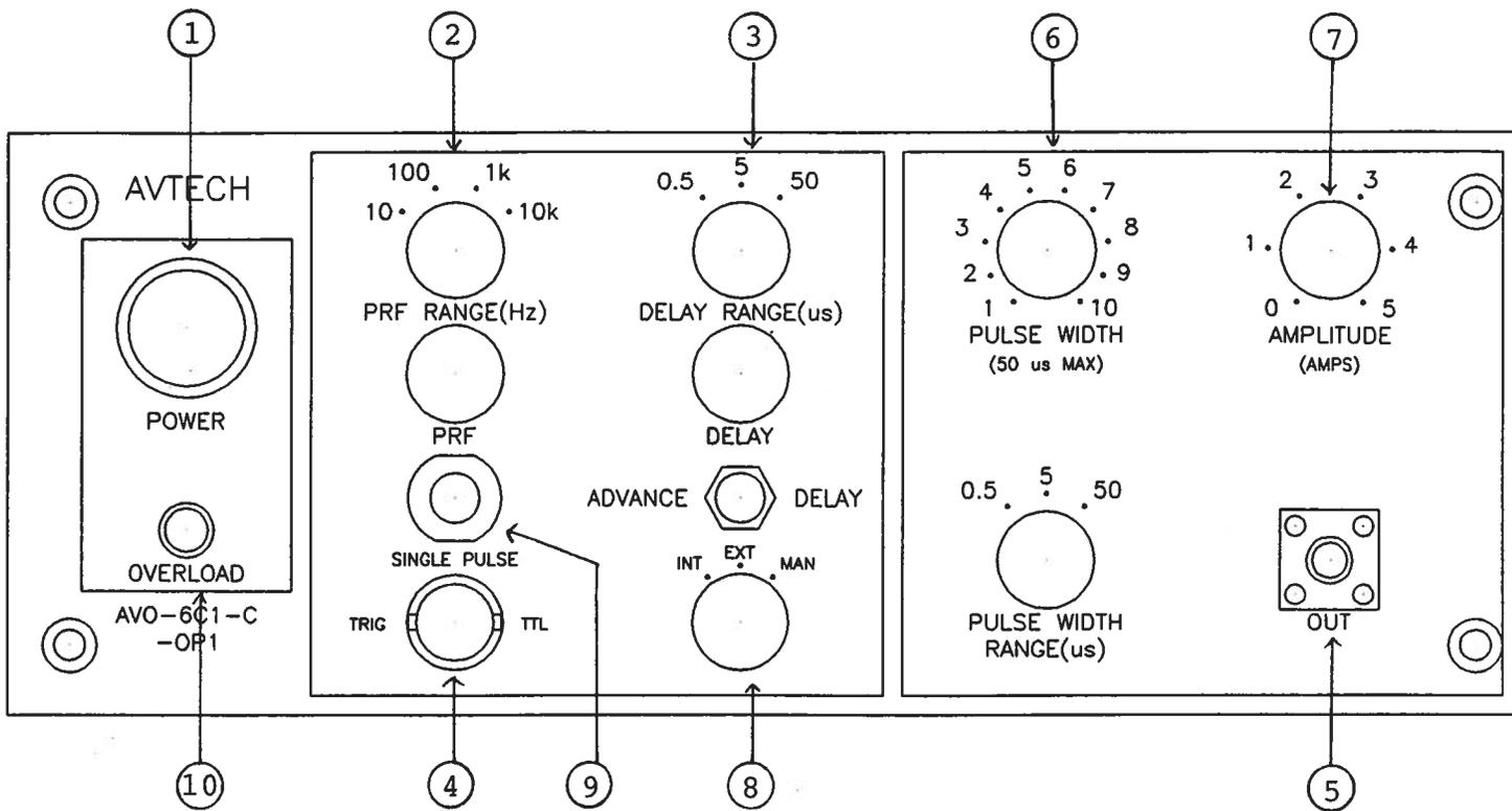
FIG 4: FRONT PANEL CONTROLS
