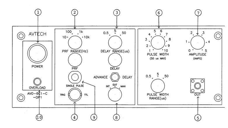
FIG 4: FRONT PANEL CONTROLS
