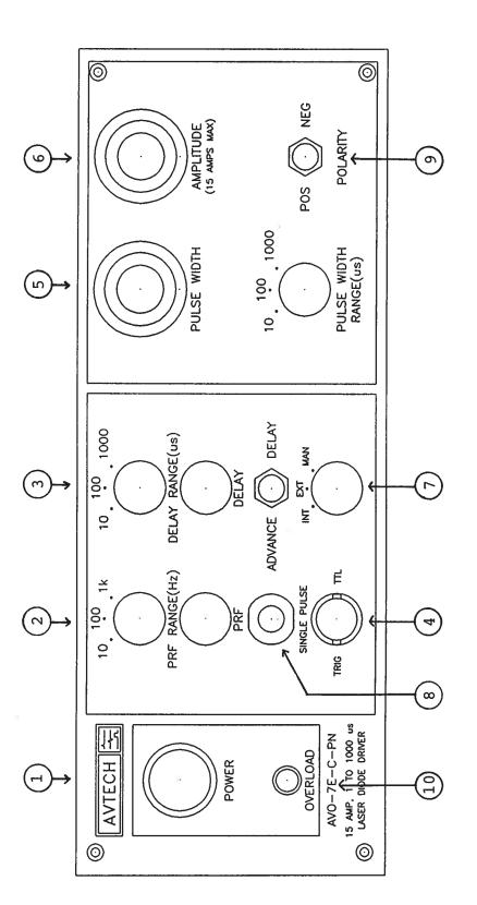
FIG 2: FRONT PANEL CONTROLS
