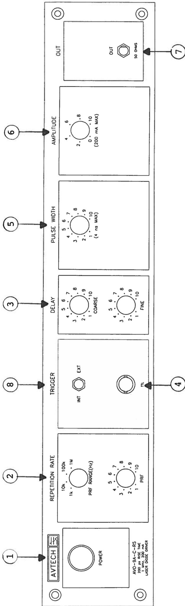
FIG. 3: FRONT PANEL CONTROLS
