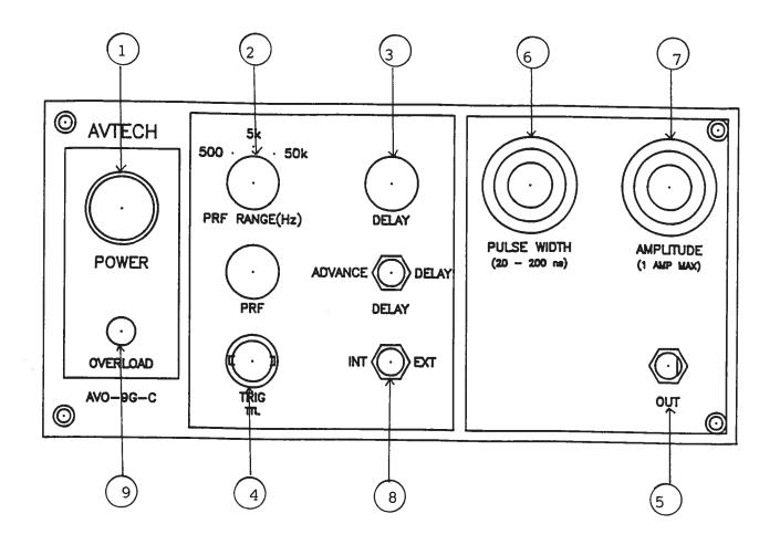
Fig. 3 FRONT PANEL CONTROLS
