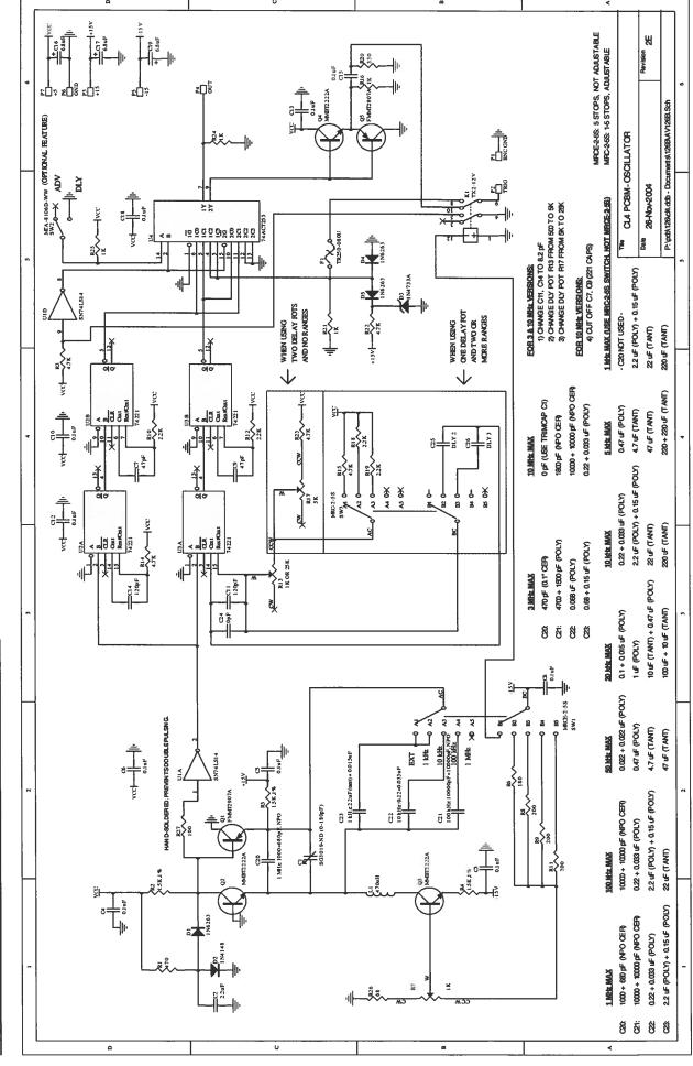
PCB 126B - OSCILLATOR AND TRIGGER CIRCUIT
