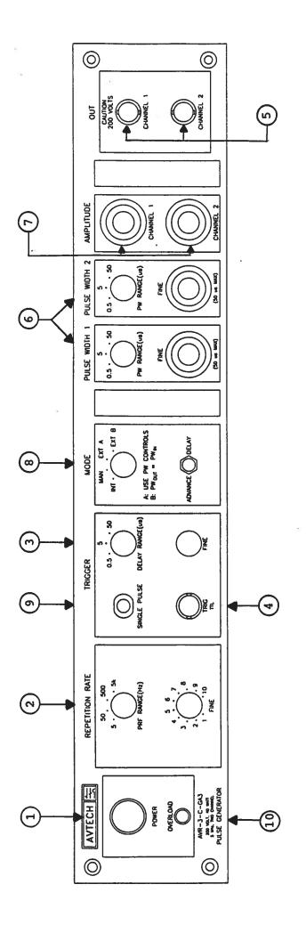
FIG. 2: FRONT PANEL CONTROLS
