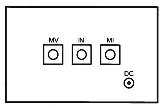
AVX-S1-HC-P1-LT3 OUTPUT MODULE, CONNECTOR VIEW
