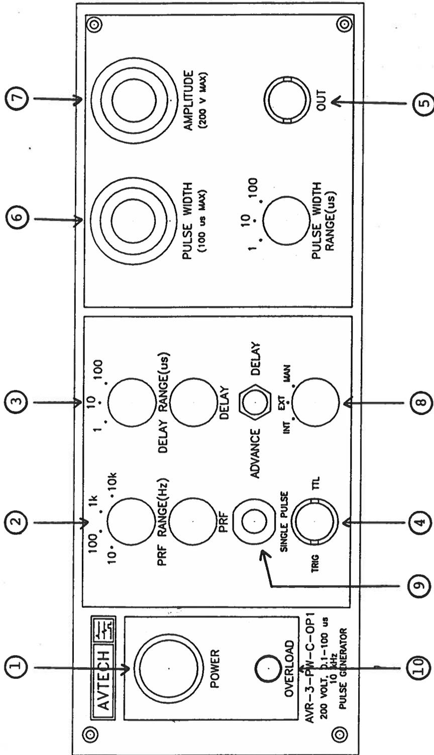
Fig. 2 FRONT PANEL CONTROLS
