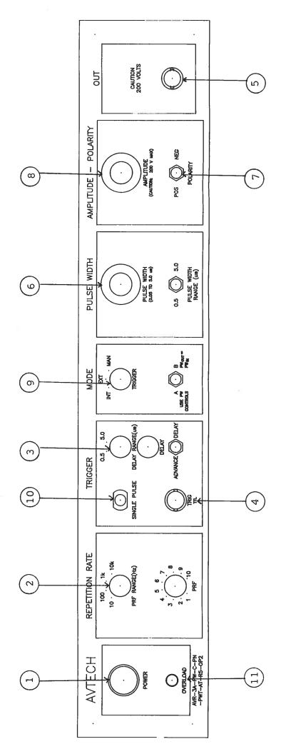
Fig. 2 FRONT PANEL CONTROLS
