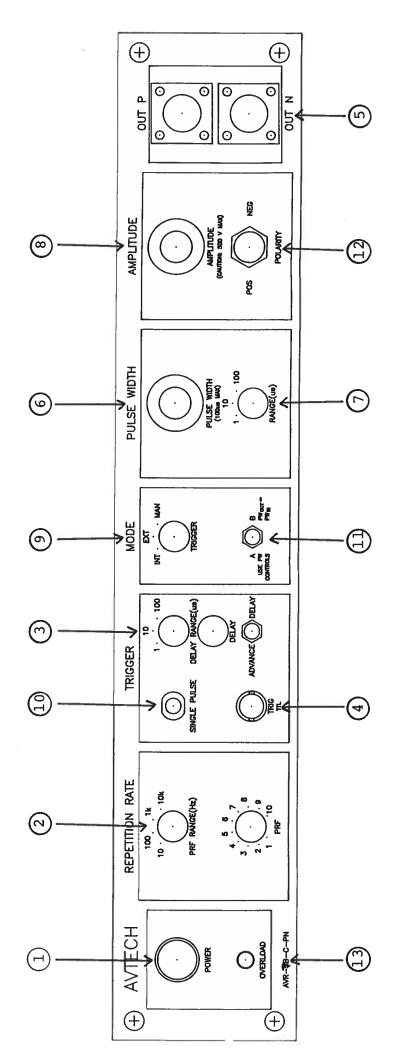
Fig. 2 FRONT PANEL CONTROLS
