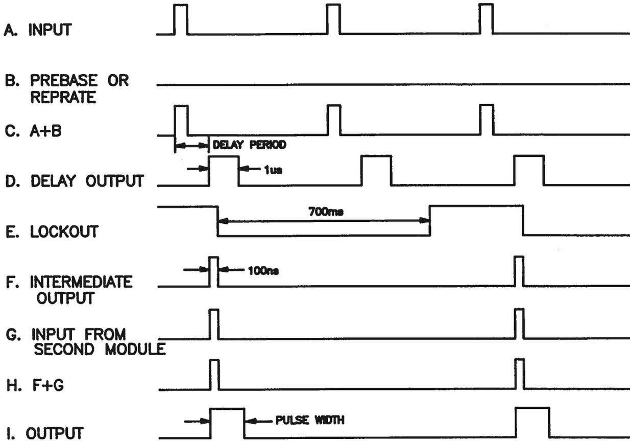
**FIG. 4B -- TYPICAL OPERATION, LOCKOUT OFF**
