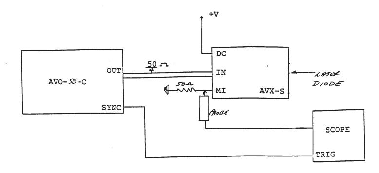
Fig. 2 FUNCTIONAL EQUIVALENT CIRCUIT
