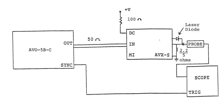
Fig. 2 FUNCTIONAL EQUIVALENT CIRCUIT
