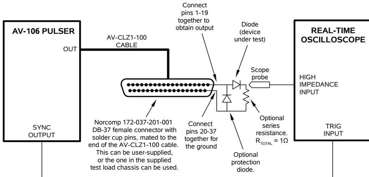
NOTE: BOTH DIODES ARE SHOWN ORIENTED FOR A POSITIVE OUTPUT. REVERSE BOTH DIODES FOR NEGATIVE OPERATION.
